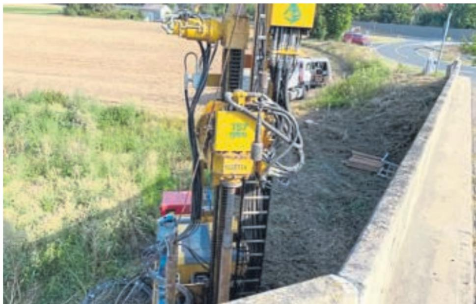
**Sondierung des Untergrundes:** Derzeit wird von einer Spezialfirma der Boden unter der Brücke untersucht. FOTO: PRIVAT/ NH
